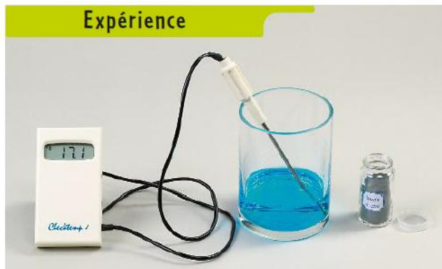
A On relève la température d'une solution de sulfate de cuivre contenue dans un cristalliseur.
