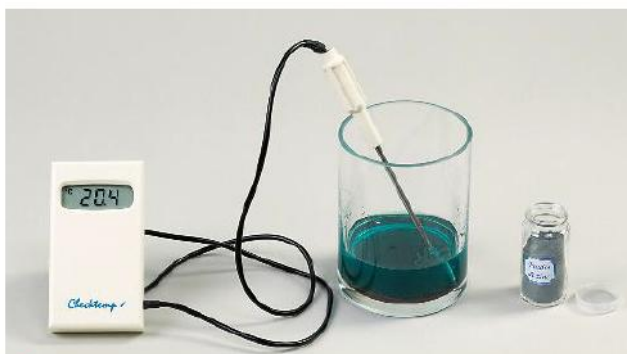
C On agite et quelques minutes plus tard on relève à nouveau la température. Une évolution de température indique l'apparition ou la disparition d'énergie thermique.
