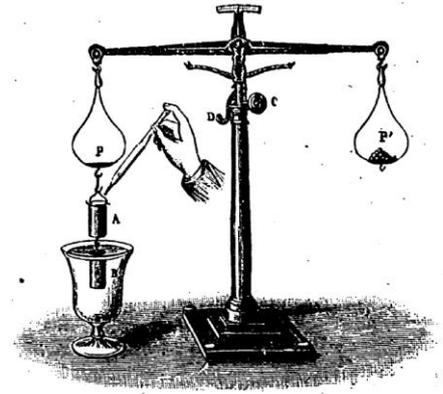
**Doc 1** Lorsque le fléau de la balance est horizontal, on détermine la masse de l'objet.
