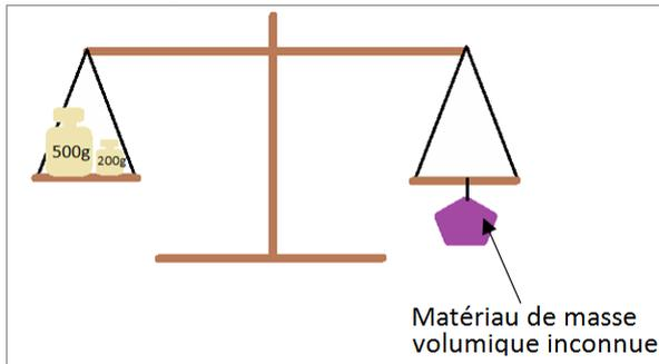
**Doc 2** Lorsqu'on plonge l'objet dans l'eau, la masse nécessaire pour équilibrer la balance diminue.
